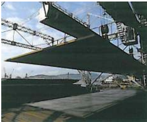
リフティングマグネットによる、 ライン直結の配材
