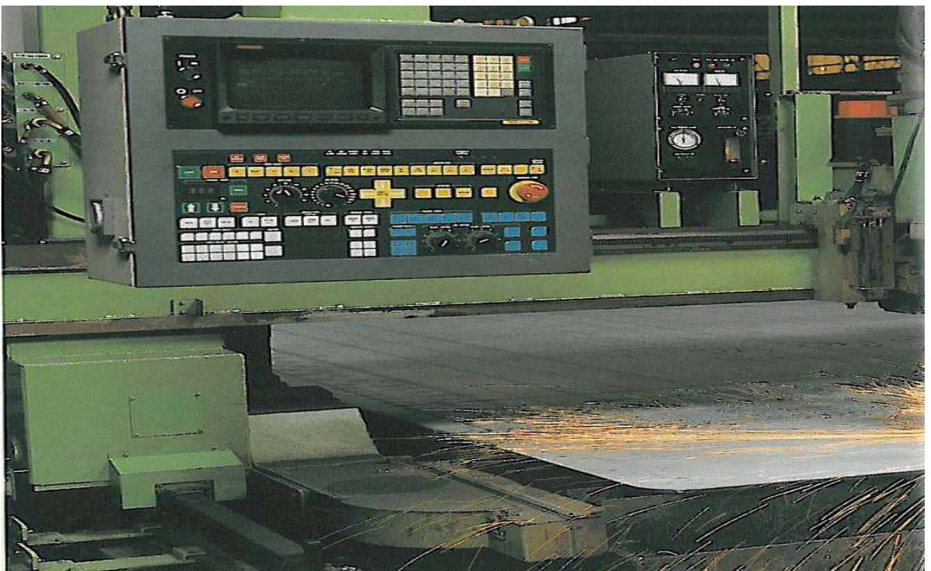
鋼材をハイスピードで精密切断するプラズマ切断機
